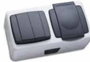
İkili Nemliyer Komütatör + Kapaklı Topraklı Priz 37064203 10 AX, 250 V~ / 16 A, 250 V~ EN 60669-1 / IEC 60884-1 Kutu / Koli Adedi - 6 / 60
